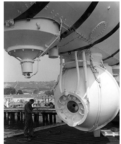
Buncărul de balast al unui batiscaf
